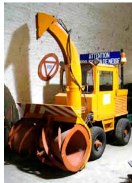
La fraise hydraulique ROLBA de 1972 montée sur un porteur ROLBA. Dans le Musée de la Route à Mons
