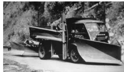
Saviem avec étrave, aileron écreteur et lame tractée
